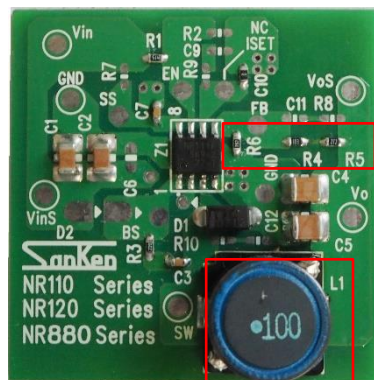
図 8-2 出力電圧設定抵抗とインダクタ
