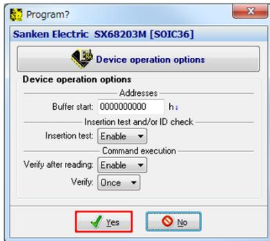
パラメータの書き込み処理が始まります。書き込み処理が始まると [Info] ウィンドウの [Programmer] ペインで、状態表示の [BUSY] が点灯します。書き込み処理が完了すると [BUSY] が消灯し [GOOD] が点灯します。書き込み処理に失敗した場合 [ERROR] が点灯します。
