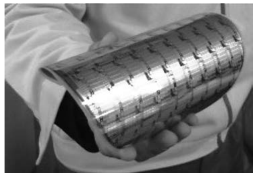
図5 8インチ極薄ウェーハ 8-inch ultra-thin wafer
