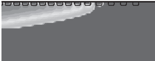
図8 空乏層シミュレーション結果 Simulation result of depletion layer
