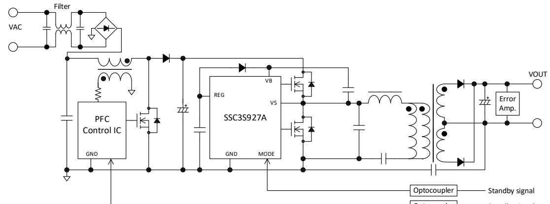
Xコンデンサの放電抵抗、高圧コンデンサ、補助電源回路が削除でき、部品点数を大幅に削減。
