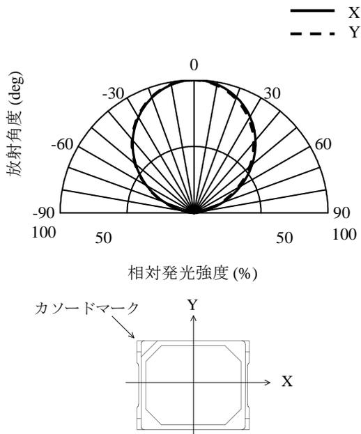
図7 指向性 (T<sub>A</sub> = 25 °C、I<sub>F</sub> = 50 mA)
