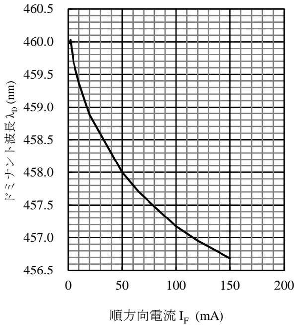
図5 λ<sub>D</sub> - I<sub>F</sub> 特性 (T<sub>A</sub> = 25 °C)
