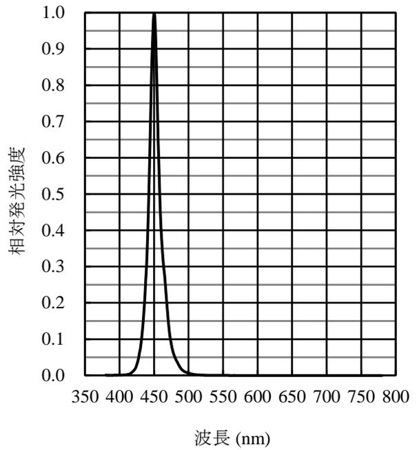
図6 発光スペクトル分布 (T<sub>A</sub> = 25 °C、I<sub>F</sub> = 50 mA)
