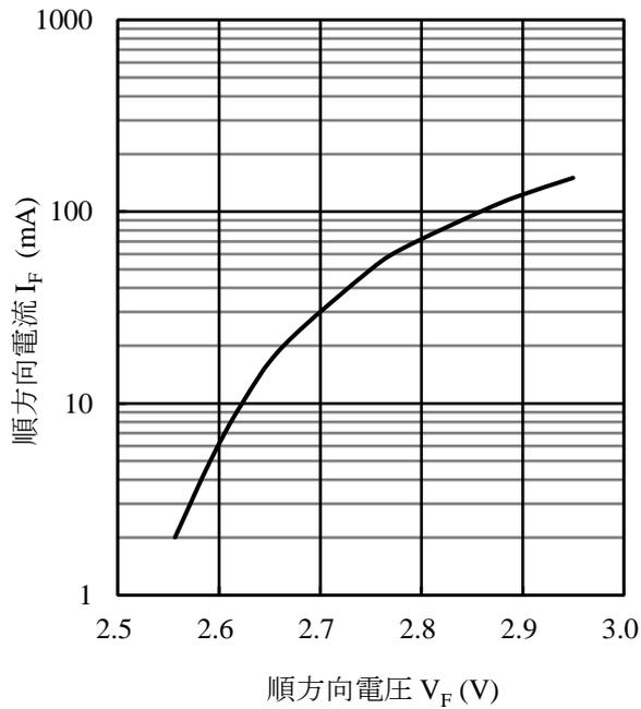
図3  $I_F - V_F$  特性 ( $T_A = 25^\circ\text{C}$ )
