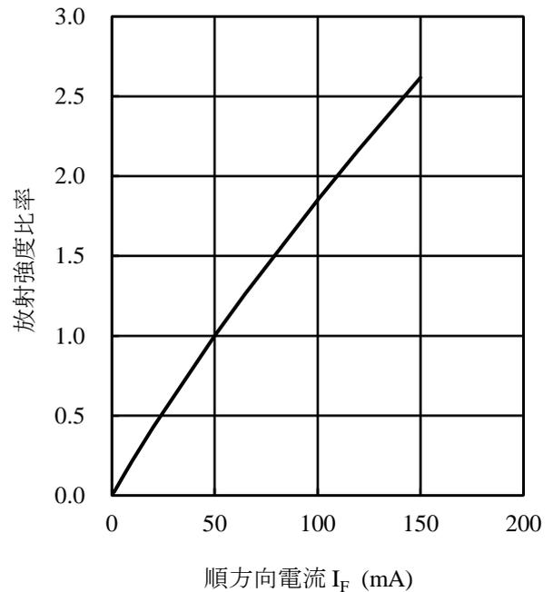
図4 放射強度比率 -  $I_F$  特性 ( $T_A = 25^\circ\text{C}$ )
